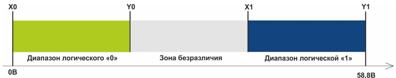
Рисунок 7 - Диапазоны дискретных состояний
